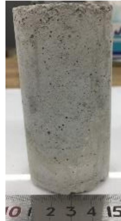
$\phi 50 \times 100 \text{mm}$ 、4.2MPa
