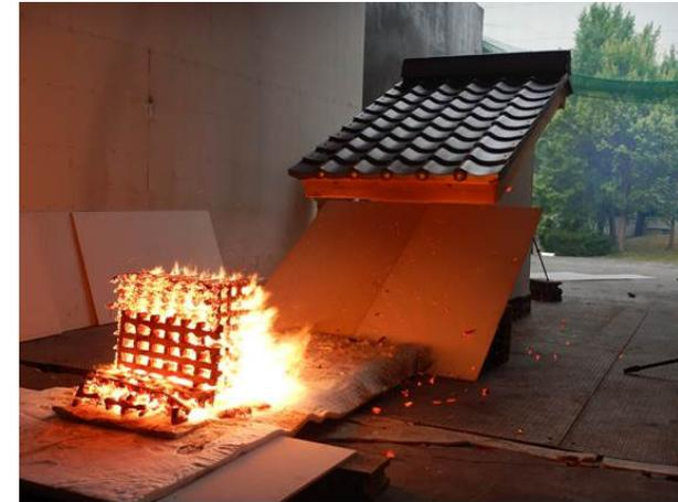
屋根・軒を介した飛び火の実験
